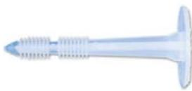
Es un anclaje diseñado para fijación de aislante rígido, tipo poliestireno expandido sobre materiales macizos, como hormigón, ladrillo, piedra o madera maciza. Su diseño en forma de cuña y aletas permite quedar firmemente anclado al material base. La cabeza plana en forma de arandela soporta la colocación mediante percusión, a la vez que comprime el material aislante.
