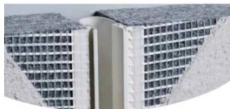
Perfil de PVC con malla de fibra de vidrio álcali resistente para el tratamiento de juntas de dilatación verticales y planas en fachadas con sistemas de aislamiento térmico por el exterior E.I.F.S, de acabado en capa fina
