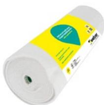
Tela para ser usada como refuerzo en los puntos de encuentro en trabajos de impermeabilización de superficies. Altamente resistente a la alcalinidad. Tiene un alto contenido de celulosa lo que permite la impregnación del impermeabilizante a utilizar.
