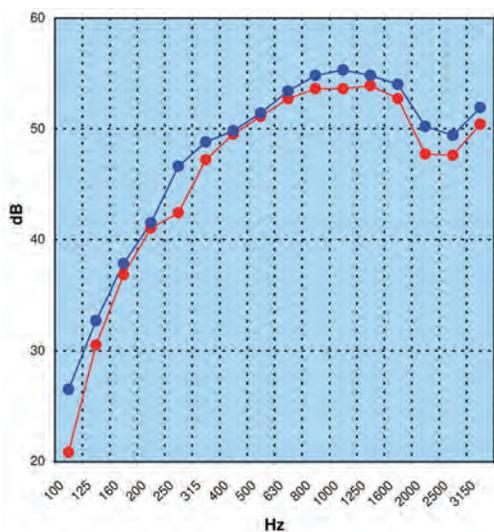
● Tabique de acero galvanizado con 2 planchas de Volcanita RF 15 mm + Montante de 60 mm + Aislanglass R141 + 2 Volcanita RF 15 mm.
