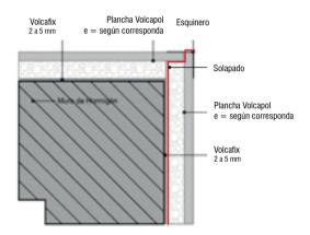
• En zonas de bordes expuestos de la placa Volcapol, se recomienda realizar un rebaje de 2,5 cm del poliestireno expandido a la vista, para luego ser rellenado con el adhesivo Volcafix.
