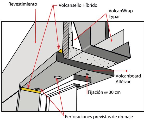
**Detalle de instalación de Volcanboard Alféizar en paredes de hormigón:**
