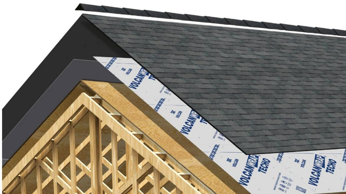
Esquema de armado del sistema membrana - teja asfáltica
